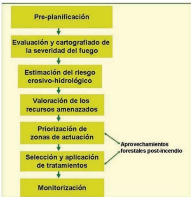
Figura 19. Diagrama de flujo de las medidas de estabilización de emergencia de áreas forestales quemadas.
