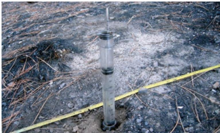
Figura 53: Uso del mini-infiltrómetro de disco en campo para estimar el grado de repelencia al agua en el suelo quemado. (Fotografía: Cristina Fernández).
